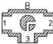
**Schema di montaggio sfera a "L"**
