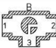
**Schema di montaggio sfera a "L"**
