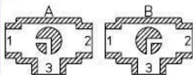
Schema di montaggio sfera a "L"
