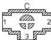
N.B. con attuatore SR scegliere la posizione di riposo della sfera tenendo presente che, se alimentato, l'attuatore ruota in senso antiorario.
