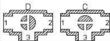
N.B. con attuatore SR scegliere la posizione di riposo della sfera tenendo presente che, se alimentato, l'attuatore ruota in senso antiorario.
